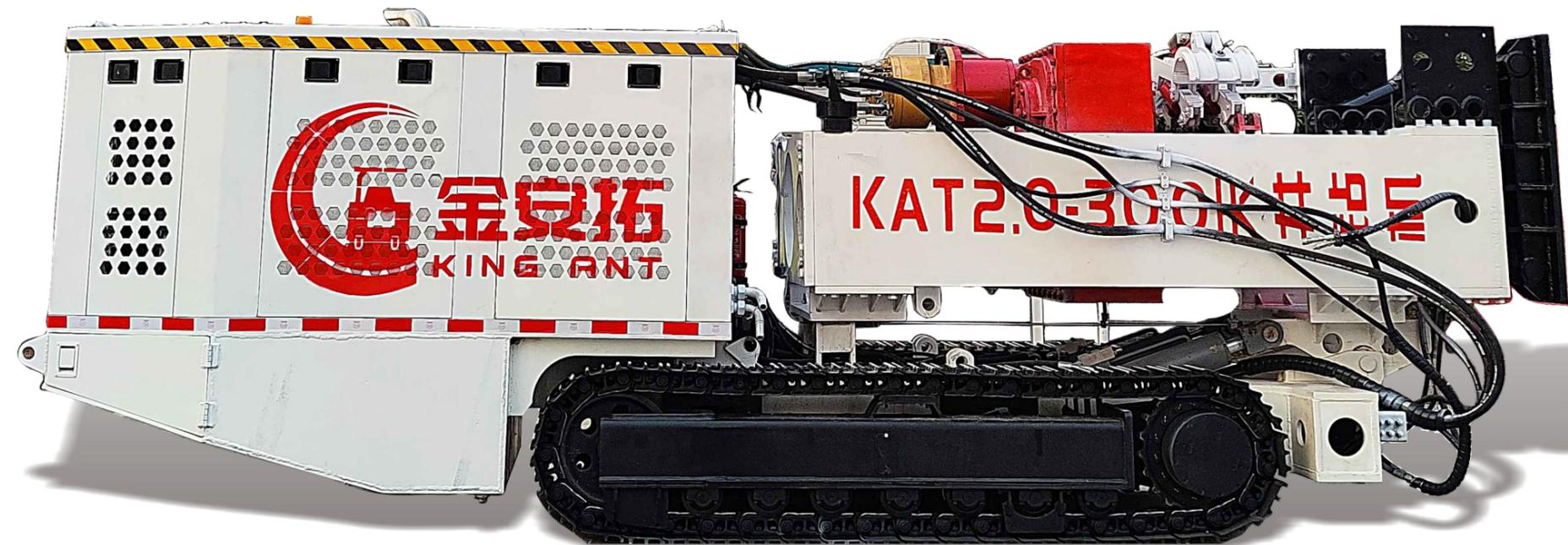
KAT2.0-300 well rig/Восстающая буровая установка машина KAT2.0-300
